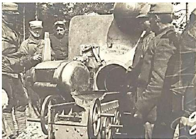
Près de Trigny, pièce de 370 sur voie ferrée ; la culasse ouverte pour recevoir la charge
